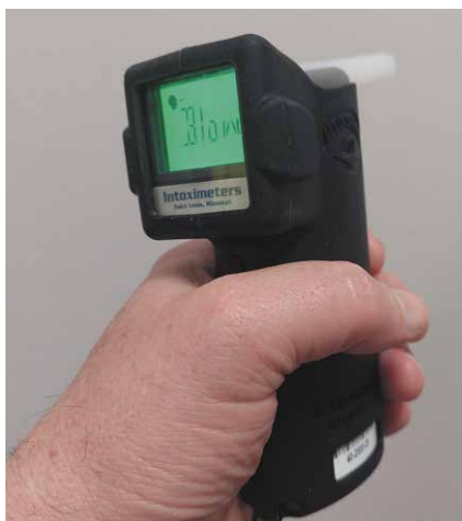
Photo 1 : Ethylomètre AlcoSensor FST. © DR
